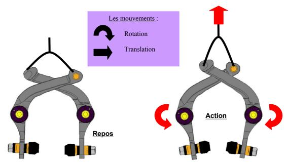
5° Sur le schéma ci dessous, complète la partie manquante du mécanisme (cadre en pointillés) ainsi que le diagramme de fonctionnement.
