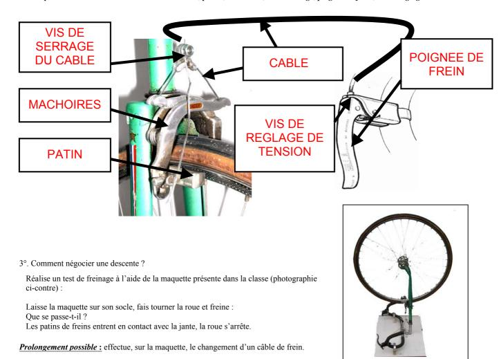
4° A partir de l'observation du fonctionnement du système de freinage, complète le dessin en utilisant les symboles de la légende cidessous :
